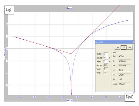
الشكل (15) : منحنى تافل لصلب الكربوني C35 غير المعالج في محلول كلوريد الهيدروجين HCl
