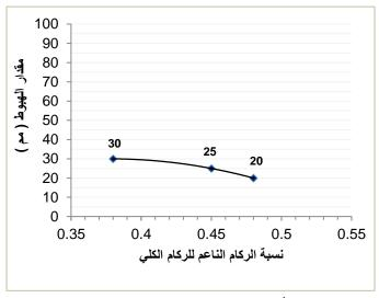
شكل (9): تأثير نسبة الركام الناعم للركام الكلي علي التشغيلية لنسبة ماء للإسمنت 0.45 ونسبة إضافات ملانة للإسمنت 1.5
