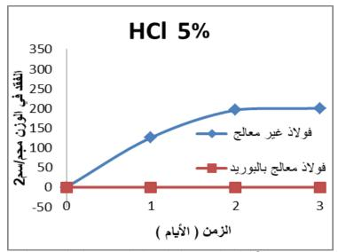
الشكلُ (7) : معدلات التآكل لفقد الوزن بدلالة الزمن لصلب 35 المعالج وغير المعالَّج في كلوريد الهيدروجين HCl.
