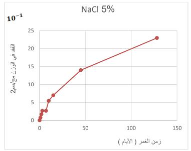
الشكل (4) : معدلات التآكل لفقد الوزن بدلالة الزمن في ملح الطعام NaCl
