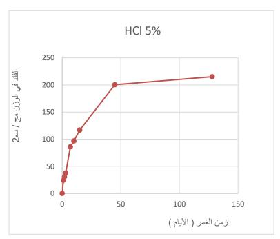
الشكل (2): معدلات التآكل لفقد الوزن بدلالة الزمن في كلوريد الهيدروجين اHCl
