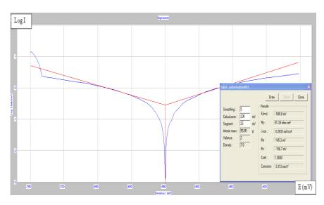
الشكل (13) : منحنى تافل لصلب الكربوني C35 غير المعالج في محلول حمض الكبريت  $H_2SO_4$
