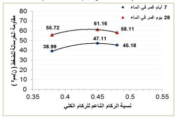
شكل (4): تأثير نسبة الركام الناعم للركام الكلي علي مقاومة الضغط لنسبة ماء للإسمنت 0.50 ونسبة إضافات ملانة للإسمنت 1.5
