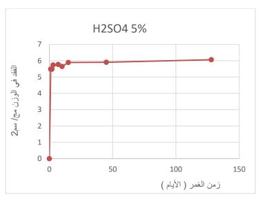
$H_2SO_4$  الشكل (3) : معدلات التآكل لفقد الوزن بدلالة الزمن في حمض الكبريت
