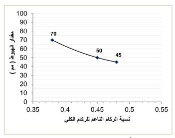
شكل (7): تأثير نسبة الركام الناعم للركام الكلي علي التشغيلية لنسبة ماء للإسمنت 0.50 ونسبة إضافات ملانة للإسمنت 1.0
