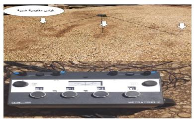
شكل (9) يوضح الجهاز المستخدم لقياس مقاوميه التربة
