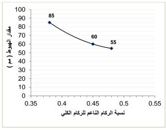
شكل (8): تأثير نسبة الركام الناعم للركام الكلي علي التشغيلية لنسبة ماء للإسمنت 0.50 ونسبة إضافات ملدنة للإسمنت 1.5
