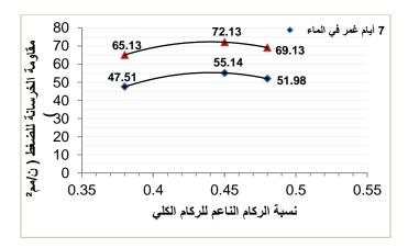
شكل (6): تأثير نسبة الركام الناعم للركام الكلي علي مقاومة الضغط لنسبة ماء للإسمنت 0.45 ونسبة إضافات ملانة للإسمنت 2.0
