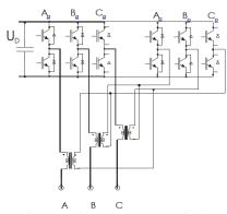
الشكل (5): دائرة القدرة الكهربائية للعاكس الجهدي ذي المتجهات المتعامدة OVT
