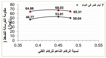
شكل (5): تأثير نسبة الركام الناعم للركام الكلي علي مقاومة الضغط لنسبة ماء للإسمنت 0.45 ونسبة إضافات ملدنة للإسمنت 1.5
