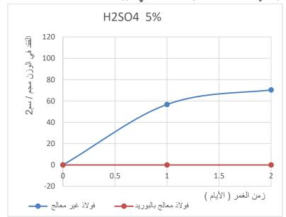
الشكل (8) : معدلات التآكل لفقدان الوزن بدلالة الزمن لصلب C35 المعالج وغير المعالج في حمض الكبريت  $H_2SO_4$
