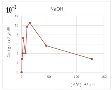
الشكل (6): معدلات التآكل لفقد الوزن بدلالة الزمن فيNaOH هيدروكسيد الصوديوم
