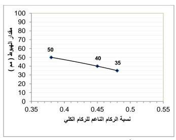
شكل (10): تأثير نسبة الركام الناعم للركام الكلي علي التشغيلية لنسبة ماء للإسمنت 0.45 ونسبة إضافات ملائة للإسمنت 2.0
