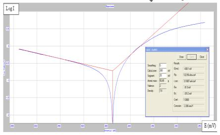
الشكل (14) : منحنى تافل لصلب الكربوني C35 المعالج في محلول كلوريد الهيدروجين HCl
