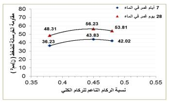
شكل (3): تأثير نسبة الركام الناعم للركام الكلي علي مقاومة الضغط لنسبة ماء للإسمنت 0.50 ونسبة إضافات ملدنة للإسمنت 1.0
